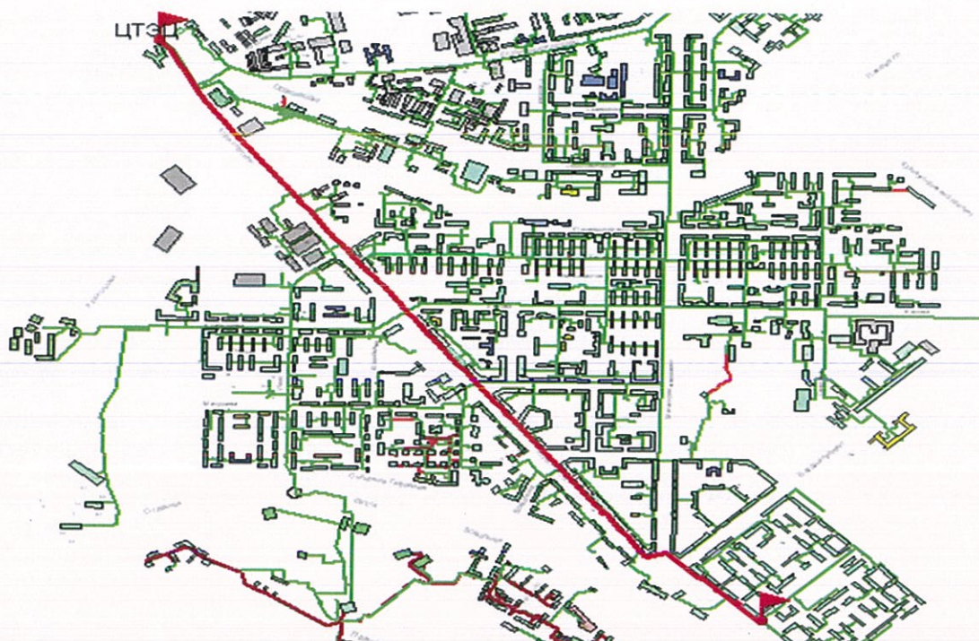
Рисунок 1.16.1. Трассировка магистрального теплопровода «ЦТЭЦ- ТК-41 Курако»
